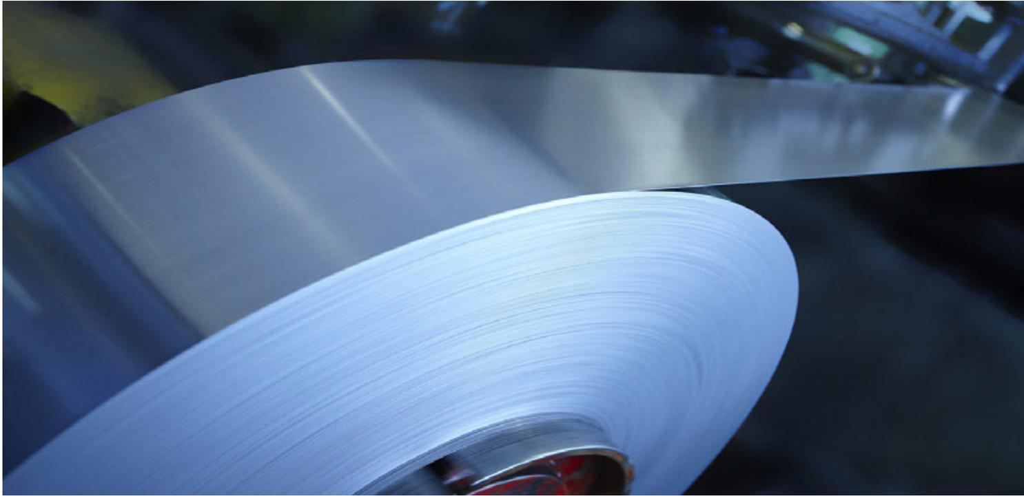
È il processo meccanico che permette di ottenere la diminuzione dello spessore del materiale attraverso il passaggio in cilindri aventi una distanza tra loro inferiore rispetto allo spessore iniziale.
