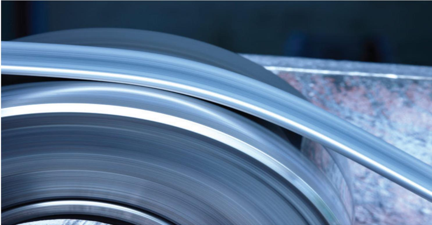
L'opération de bordage vous permet d'obtenir un bord arrondi en éliminant les bavures en trop, tout en maintenant inchangée la tolérance relative à la largeur et à l'épaisseur. Il est ainsi possible d'obtenir des bandes, echeveaux et des bandes planées.
